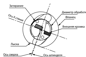
Рис. 4. Избыточное смещение (диаметр отверстия уменьшен)
