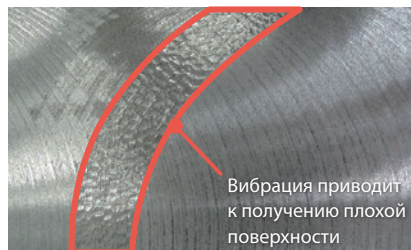
Сравнение качества обработки поверхности (оценка компании-разработчика)
