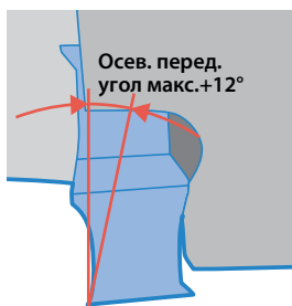
Криволинейная кромка с осев. перед. углом Макс. +12°
