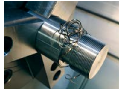
Пример переплетения стружки в клубки
