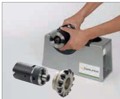
8. Вставить базовый держатель в соответствующий фланец.
