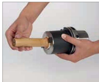
3. Очистить внутреннюю поверхность конуса и опорную поверхность
