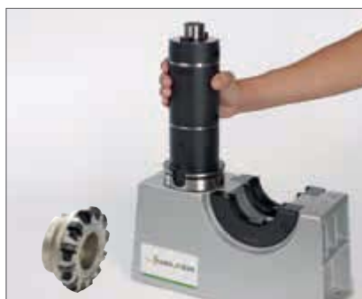
11. Установить собранный базовый держатель в коническую втулку.
