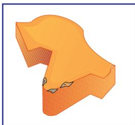
1. Используйте более прочную марку сплава
