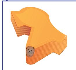
1. Используйте более прочную марку сплава
