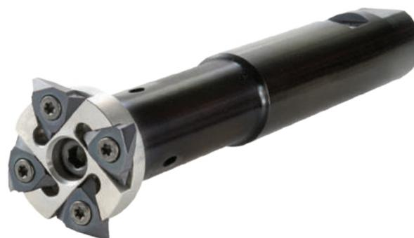
**MT7** Особомелкозернистый твердый сплав с многослойным покрытием TiAlN (ISO K10-K20) предназначенный для универсального применения по всем группам материалов при обработке на средних и высоких скоростях резания.
