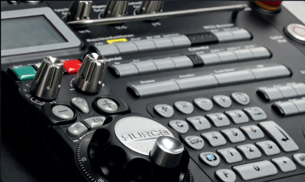
HURCO CNC-Steuerung MAX® 5 mit elektronischen Handrad.
