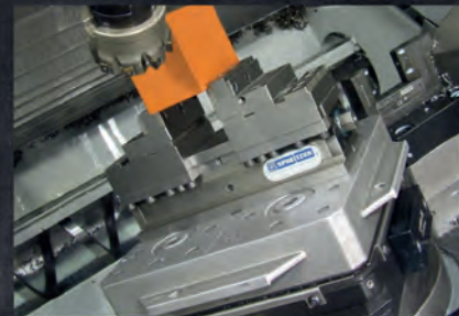
Mechanischer Zentrischspanner MZC auf Palettiersystem
