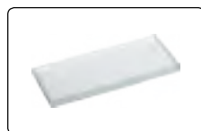
50 мм шкала отсчета (проверка погрешности увеличения)
