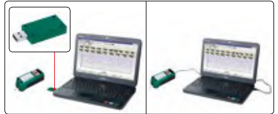
Отправка данных в Excel при подключении к компьютеру через Bluetooth или USB-кабель
