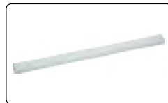
300 мм калибровочная шкала (проверка погрешности увеличения вместе с 50 мм шкалой отсчета или калибровка погрешности измерения)
