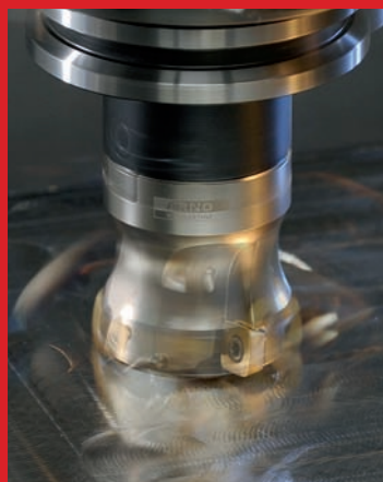
Инструмент и сменные пластины для фрезерной обработки и резьбофрезерования
