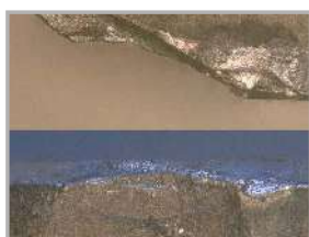
Трещина после обработки в течении 210 секунд
