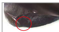
Повреждение из-за высокой нагрузки
