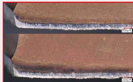
Износ по задней поверхности после сверления 60 отверстий
