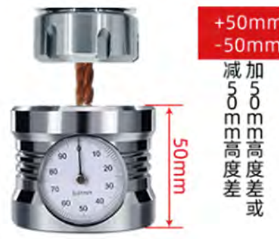
将 Z 轴设定仪置于工件上, 刀具接触测量面, 请慢速进刀使指针指在“0”则刀具与上把刀具距离同等, 与工件的高度差距离是 550\text{mm}
